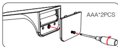
2. serrez la vis après avoir installé la batterie
