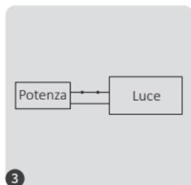
Le luci lampeggiano 3 volte lentamente significa che il collegamento è stato eseguito correttamente.
