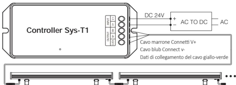
Nota: quando si utilizza "controller Sys-T1", è necessario aggiungere "Amplificatore di segnale a canale a 1 canale SYS-T2 per al di sotto di 3 situazioni.
