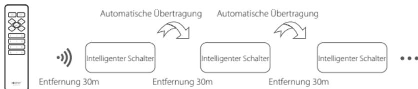
**Achtung: Alle „Smart Switch“ müssen mit einer Fernbedienung verknüpft werden.**
