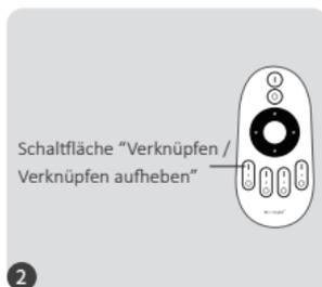
Drücken Sie die Taste " I " 5 Mal innerhalb von 3 Sekunden, wenn das Licht an ist.
