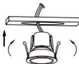
Levante el resorte e inserte la luz en el orificio.
