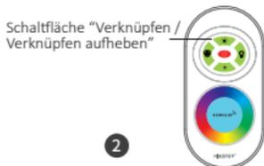
Drücken Sie die Taste "•" 5 Mal innerhalb von 3 Sekunden, wenn das Licht an ist.
