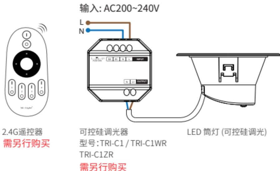
**⚠** 在上电前, 请确保所有电线连接正确和牢靠, 否则可能损坏灯具。
