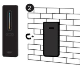
将底座贴好,遥控器磁吸在底座上
