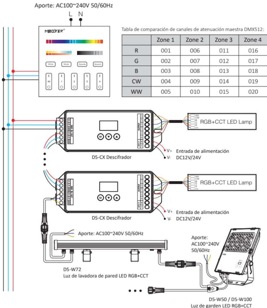
Después de conectarse con el decodificador DMX o la lámpara DMX, configure la dirección del decodificador DMX o la lámpara DMX como se muestra a continuación:
