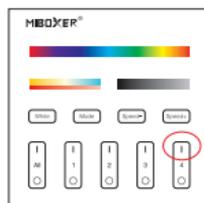
2. Presione brevemente cualquier canal "1" 3 veces, cuando se enlace con éxito, la lámpara indicadora maestra DMX512 parpadeará 3 veces lentamente.
