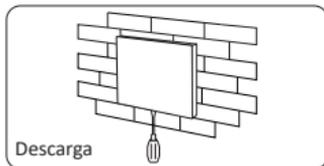
Inserte la bayoneta a continuación con un destornillador y un destornillador de urdimbre, y luego puede quitar el controlador.
