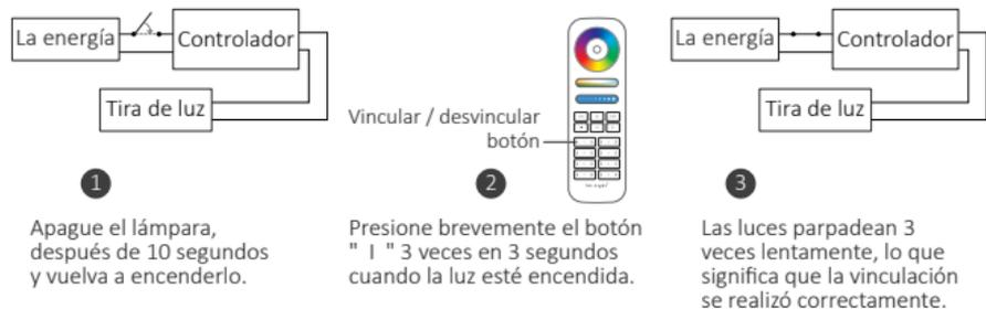
Apague el lámpara, después de 10 segundos y vuelva a encenderlo.
